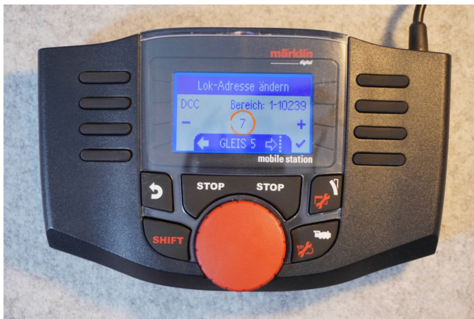
Abbildung 24: Der Dialog „Lok-Adresse ändern“ der mobile station mit der eingestellten DCC-Adresse 7
