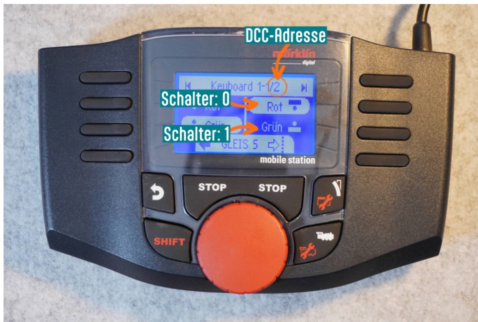
Abbildung 21: Das Keyboard der Märklin mobile station: oben die Adresse, daneben die rote Taste als Schalter 0 und die grüne als Schalter 1
