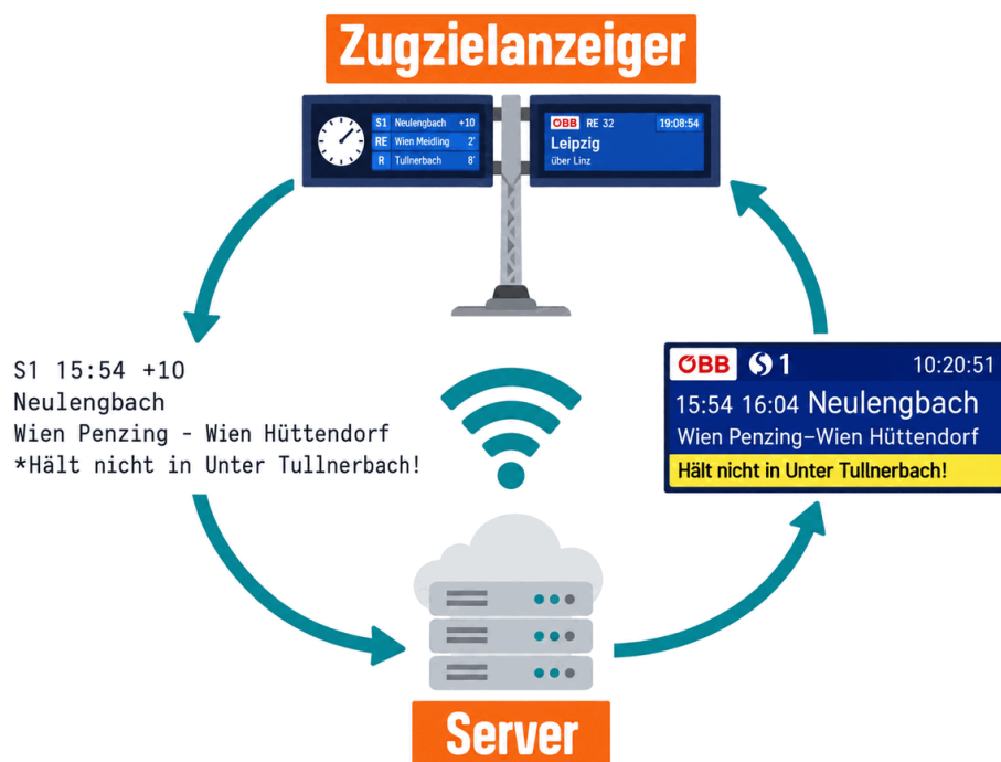
Abbildung 17: Kreislauf: Der Anzeiger schickt seine Zugdaten an den Server, der daraus ein Bild im gewählten Design erzeugt und zurückschickt
