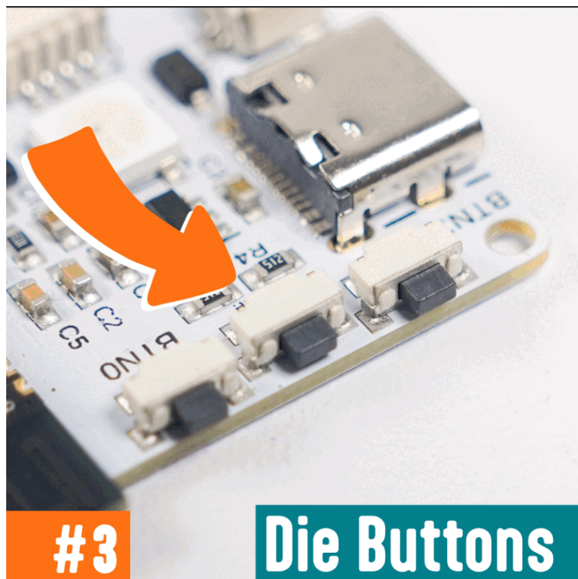
Abbildung 1: Die drei Taster an der Seite des Controllers, darunter BTN 0
