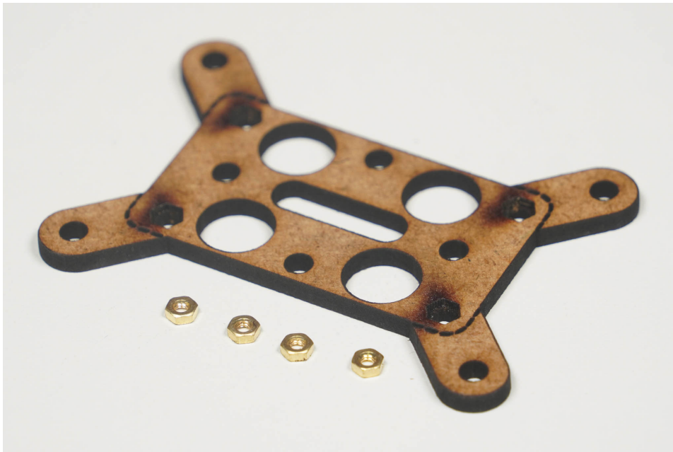
Abbildung 3: Controller-Halter mit den vier sechseckigen Vertiefungen, daneben liegen vier Messingmuttern
