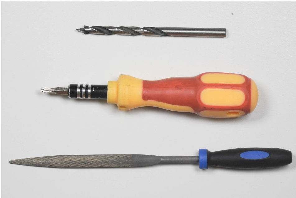
Abbildung 2: Ein 5-mm-Holzbohrer, ein Schraubendreher mit Kreuzschlitz-Bit und eine Flachfeile nebeneinander
