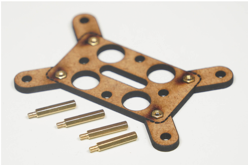
Abbildung 5: Controller-Halter mit eingesetzten Muttern, daneben die vier Messing-Abstandshalter
