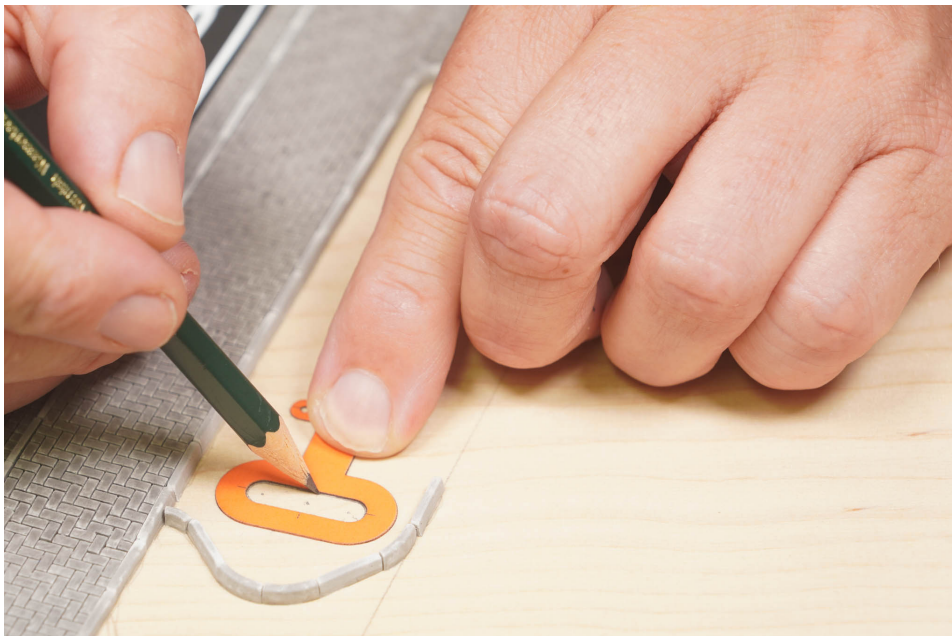
Abbildung 13: Die Umrisse des Langlochs werden mit dem Bleistift entlang der Aussparung in der Anzeichenhilfe nachgezogen
