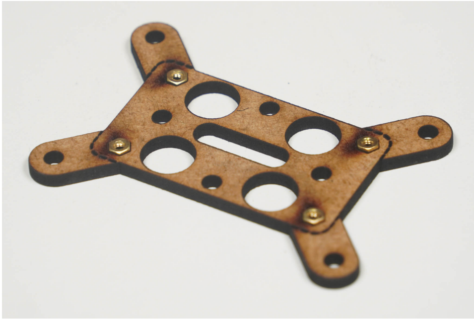
Abbildung 4: Die vier Messingmuttern liegen in den sechseckigen Vertiefungen des Controller-Halters
