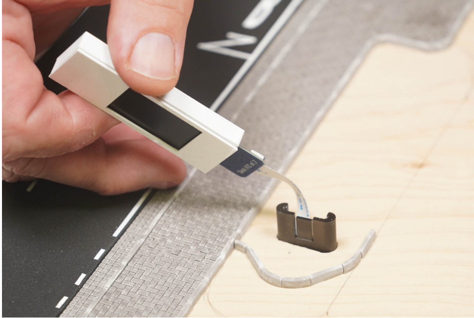
Abbildung 30: Das Display mit angeschlossenem Flachbandkabel wird über die aus der Platte ragende Schiene gehalten
