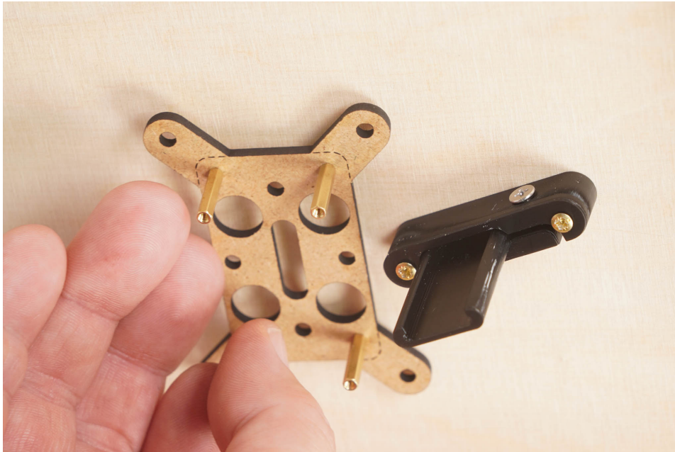
Abbildung 26: Der Controller-Halter mit vier Abstandshaltern wird unter der Platte neben der Schienenfixierung positioniert
