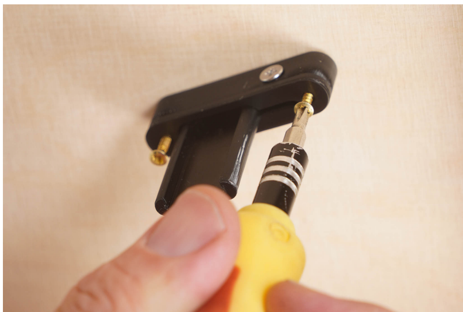
Abbildung 24: Eine der Holzschrauben wird mit dem Schraubendreher festgezogen
