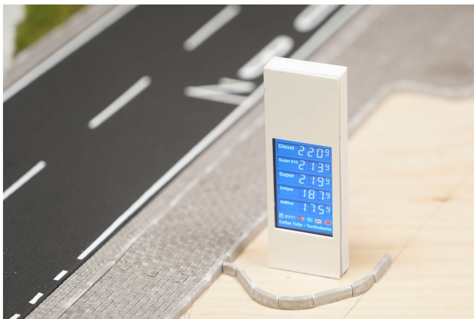
Abbildung 36: Das fertig montierte Display steht am Straßenrand auf der Anlage und zeigt Kraftstoffpreise an
