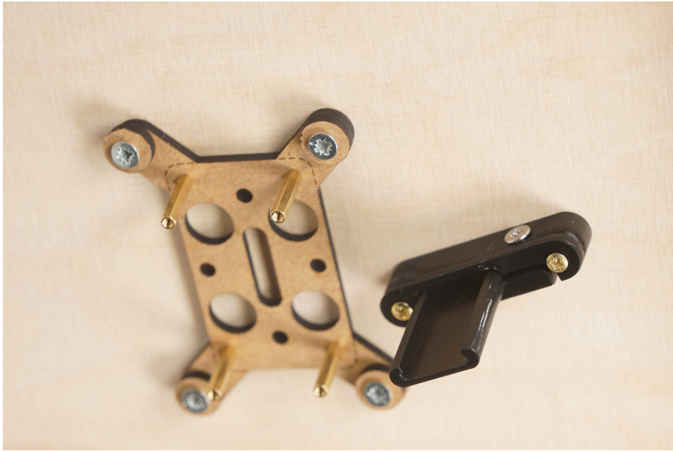
Abbildung 28: Der Controller-Halter ist mit allen vier Schrauben an der Plattenunterseite befestigt
