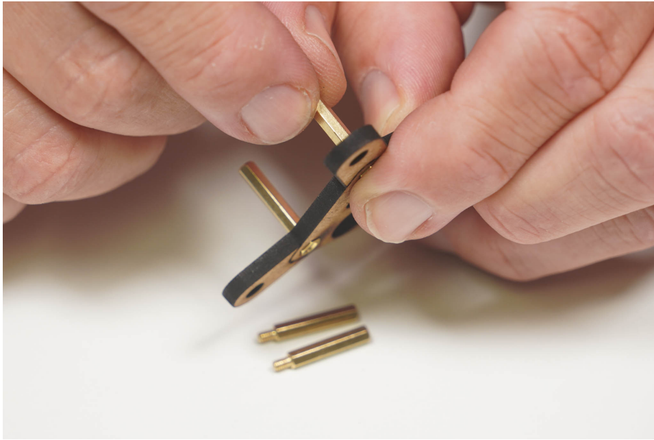
Abbildung 6: Ein Abstandshalter wird von Hand in eine der Muttern eingeschraubt
